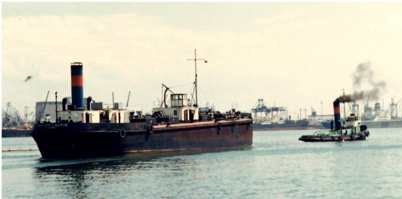
Tali unità erano rifornite di carbone con chiatte trainate da rimorchiatori. Il trasbordo del carbone veniva effettuato con ceste a spalla dai caricatori.
